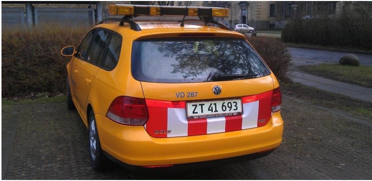
Figur 7.65 Eksempel på afmærkning af tilsynskøretøj med lygtebro og lodrette rød/hvide reflekser som spærrebom.
