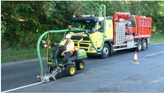
Figur 4.5 Eksempel på metode til skånsom affræsning af kørebaneafmærkning.
