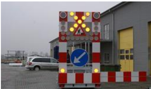
Figur 7.38 Eksempel på afspærringsvogn med sideforskydelig bom (skydebom).
